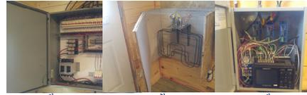
Figure 3 : Montage électrique expérimental du banc d'essai. a) Panneau électrique, b) Banc de résistance, c) Datalogger
